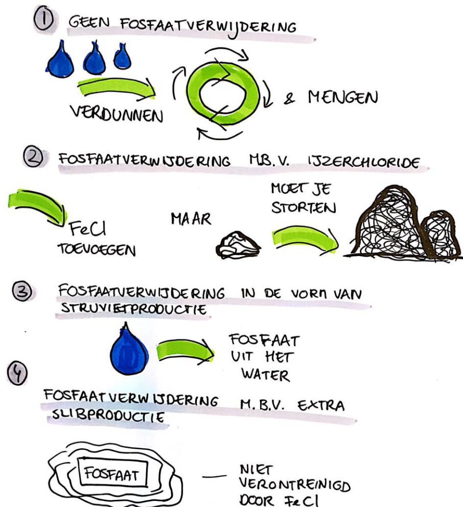
Figuur 2 Verwerkingsprocessen van blancheerwater
